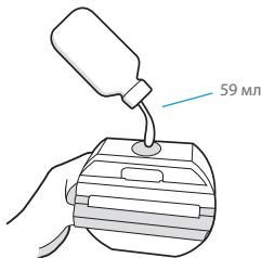
Затем заполните резервуар водой.
